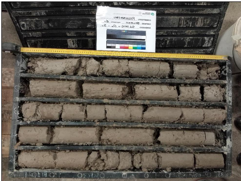
Fig. 16: esempio di cassetta catalogatrice estratta durante le operazioni di sondaggio nel diaframma
