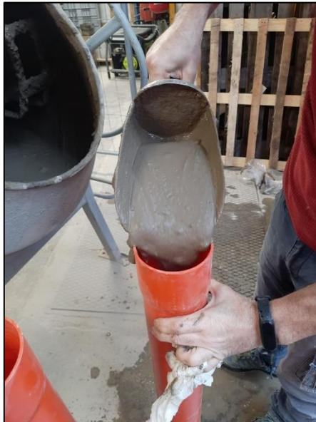
*Fig. 5: Trasferimento della miscela risultante in tubi*
