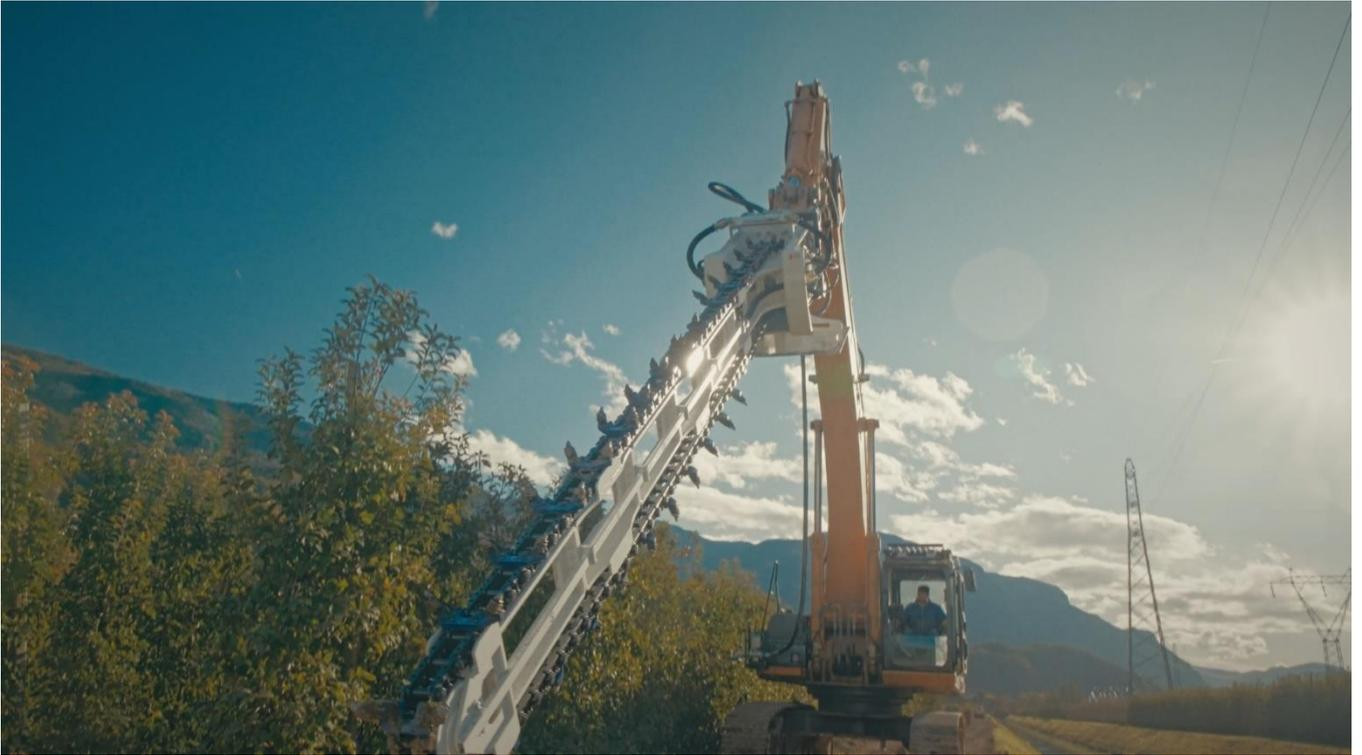
*Figura 7: escavatore con lama miscelatrice in cantiere*
