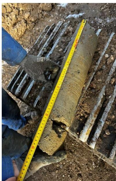
*Fig. 13: dettaglio della carota estratta durante i carotaggi orizzontali*
