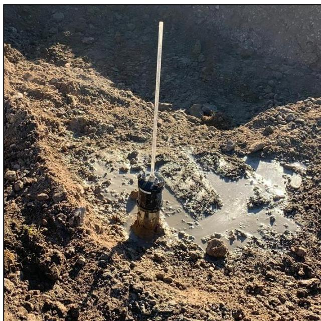
*Fig. 15: Prova di permeabilità di tipo Boutwell*
