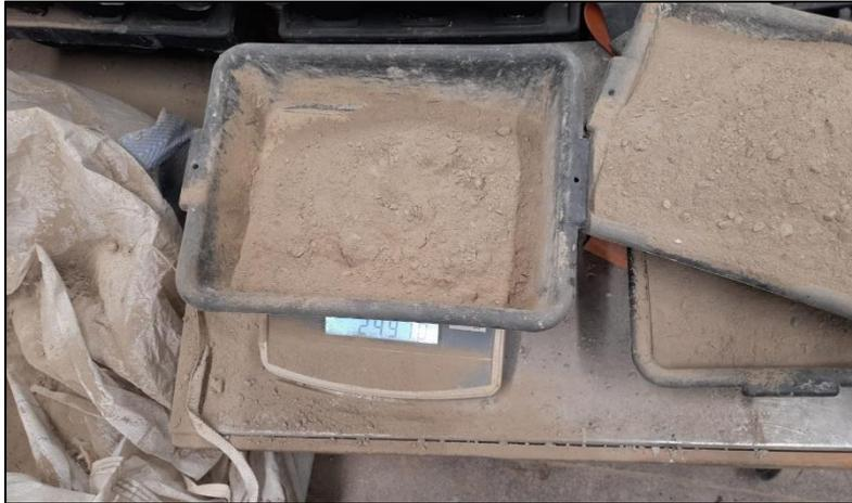
*Fig. 2: Preparazione delle quantità stabilite di terreno, acqua, cemento ed eventuale bentonite*
